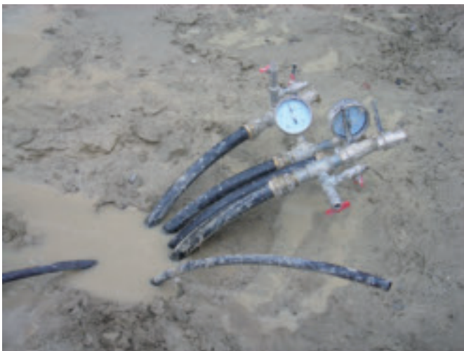
Druckprüfung von abgeteufte GEROtherm® Erdwärmesonden
