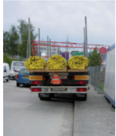
Spezialtransport für 20m GEROthem® Erdwärmepfahlsonden
