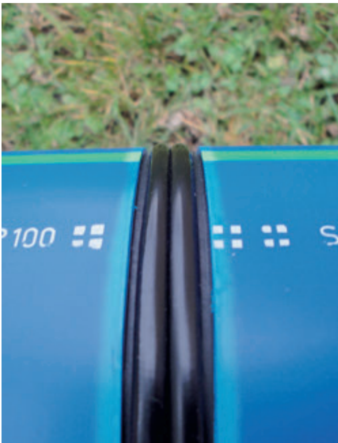
Schweissnaht an GEROfit-Schutzmantelrohr
