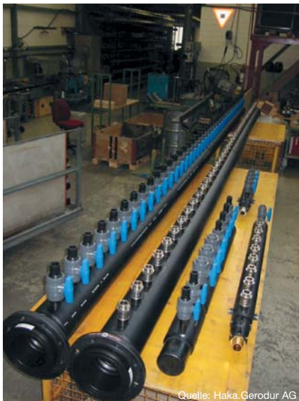
Bild 8 GEROtherm-Verteiler/Sammler Die grossen Verteiler/Sammler haben je 40 Anschlüsse für die Erdwärmesonden
