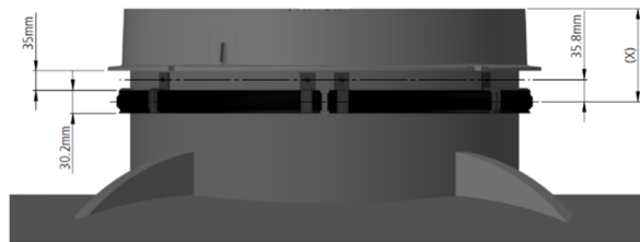
Beispiel Domhöhe 300mm mit Vollguss-Abdeckung B125
