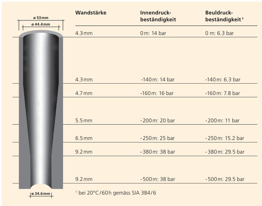
3 Wandstärkenverteilung und Druckbeständigkeit einer GEROtherm® FLUX de 53 mm Erdwärmesonde
