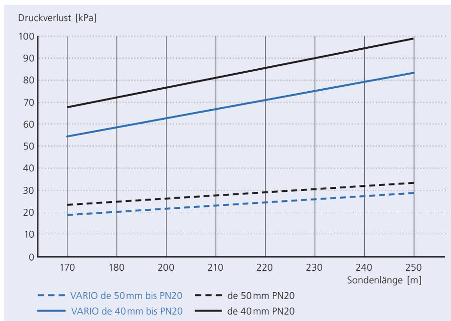
Der Druckverluste der GEROtherm® VARIO Erdwärmesonden ist im Vergleich zu einer PN20 Erdwärmesonde gemäss Abbildung 5 reduziert. Dies führt zu einem geringeren Energiebedarf für die Umwälzpumpe.
