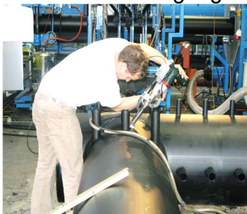
Extrusionsschweißen in der Werkstatt
