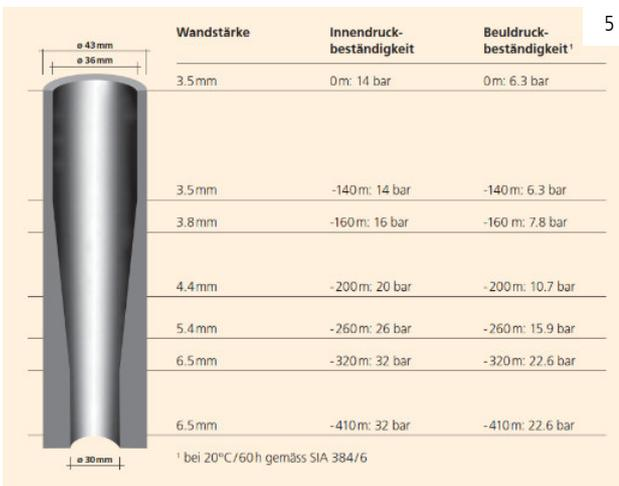
Bild 5: Wandstärkenverteilung und Druckbeständigkeit einer GEROthem® FLUX Erdwärmesonde.
