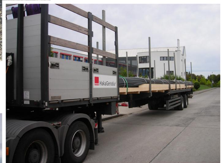
Spezialtransporter für 20m Erdwärmepfahlsonden
