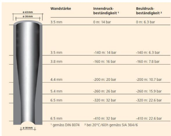
FLUX Wandstärkenverteilung und Druckbeständigkeit
