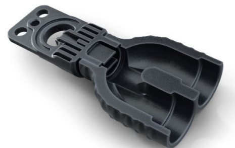
Bild 5: Höhere Belastung und Stabilität durch verstärkte Wandung am Sondenfuß; PN25 Niedriger hydraulischer Widerstand durch grosse Querschnitte und Muffenschweissung
