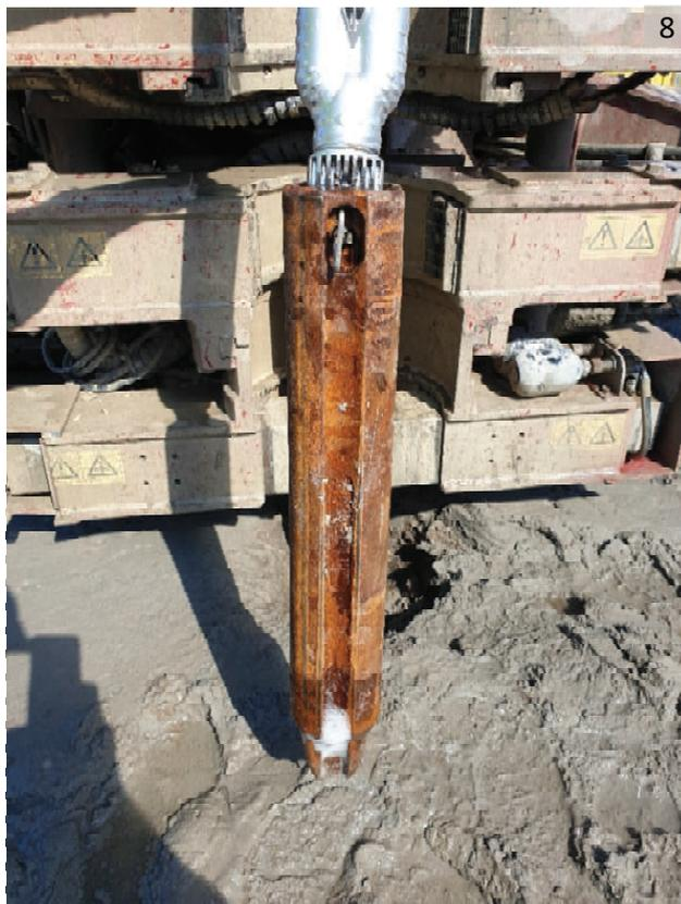
**Bild 8:** GERotherm® REX Single-U mit Erweiterungsgewicht 20kg
