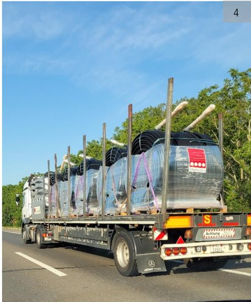
1. Erdwärmesonde GEROtherm® FLUX de 43 mm bereit für den Einbau (Bildquelle: HakaGerodur AG)
