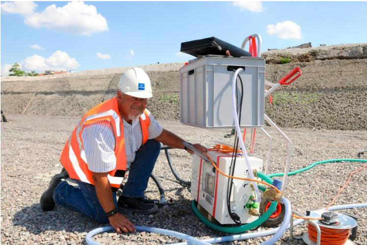
1 – Qualitätsprüfung der Erdwärmesonden mit dem Testgerät DPG-C3 der Fa. Geowatt AG
