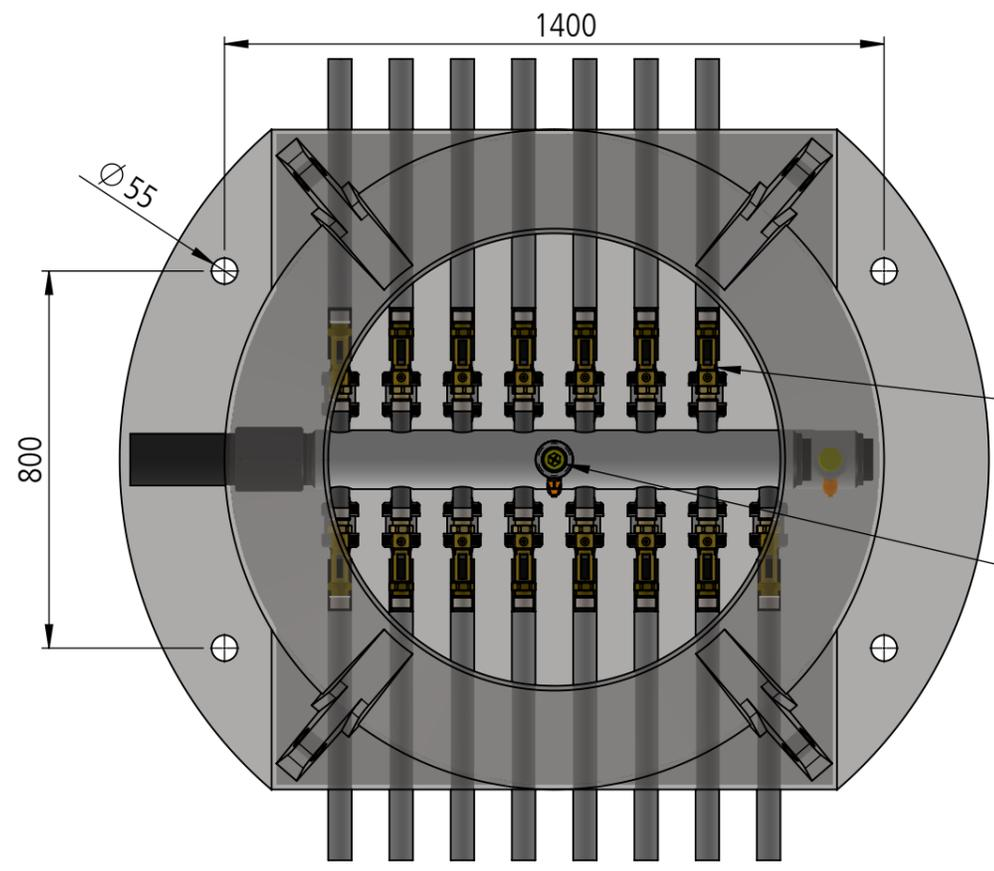
Messbereich 20-70 l/min: Art. Nr. Verteilerschacht 108584
