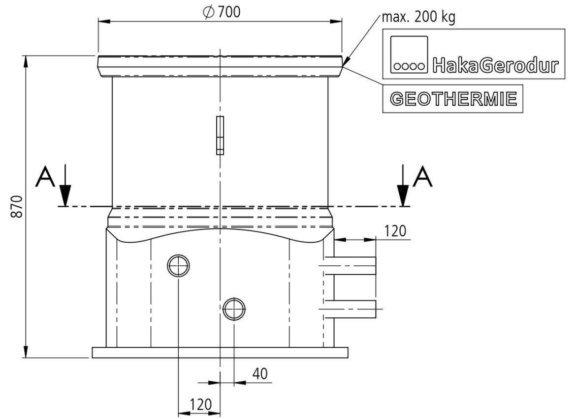
Messbereich 20-70 l/min: Art. Nr. Verteilerschacht 108426
