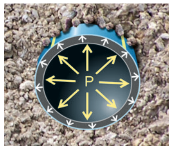
Innendruck – radiale Zugspannungen in der Rohrwand
