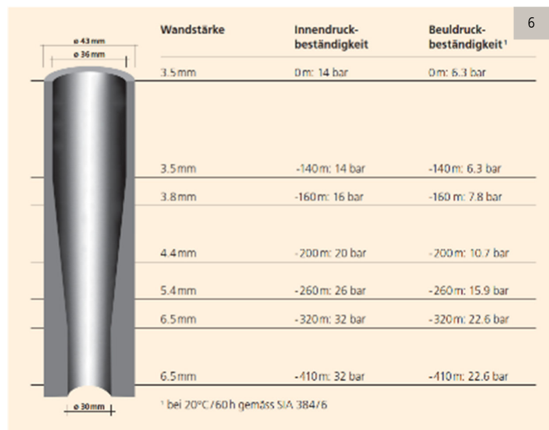
1 Wandstärkenverteilung und Druckbeständigkeit einer GEROtherm® FLUX de 43 mm Erdwärmesonde
