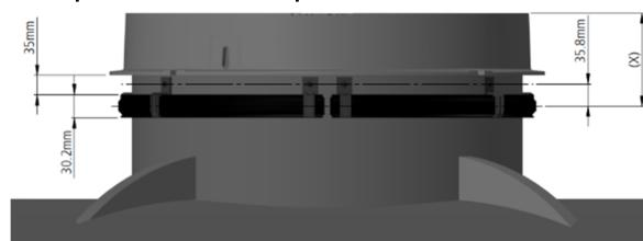
Exemple d'une hauteur de dôme de 300 mm avec couvercle en fonte B125
