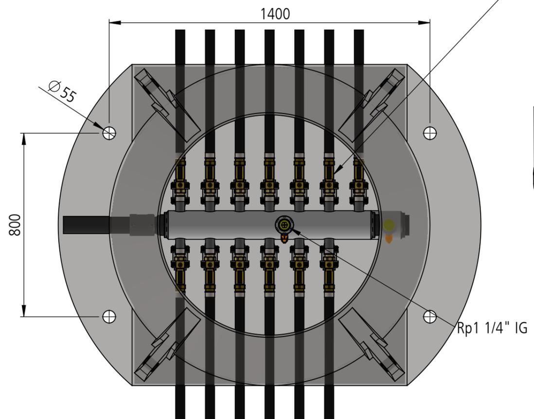
Messbereich 20-70 l/min: Art. Nr. Verteilerschacht 108566
