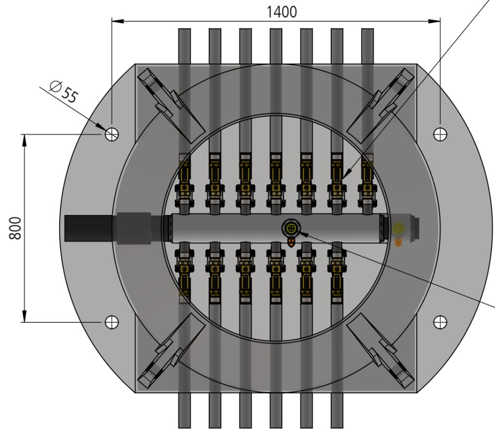
Messbereich 20-70 l/min: Art. Nr. Verteilerschacht 108570
