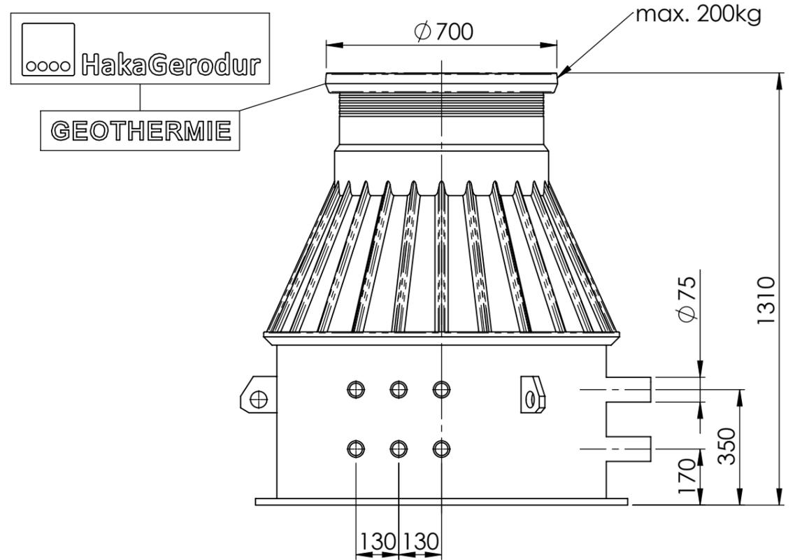
Messbereich 20-70 l/min: Art. Nr. Verteilerschacht 113301
