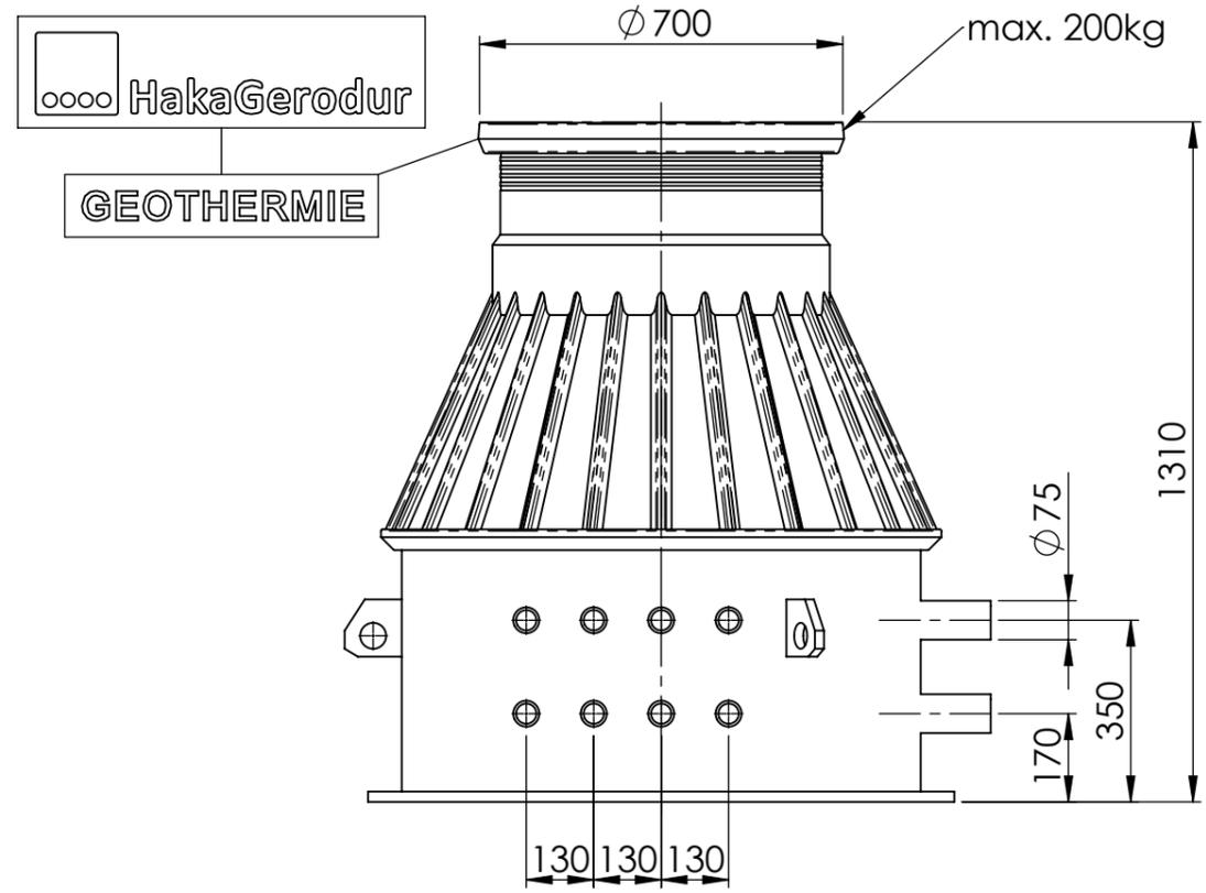
Messbereich 20-70 l/min: Art. Nr. Verteilerschacht 113302
