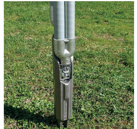
5 Poids en fonte standard monté sur le pied de la sonde
