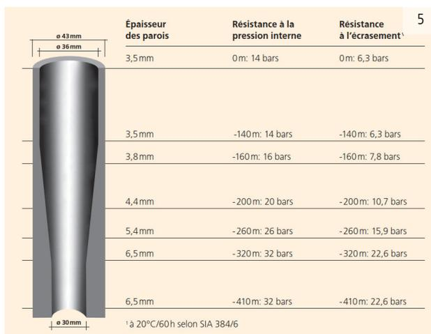
Image 5: Répartition de l'épaisseur des parois et résistance à la pression d'une sonde géothermique GEROtherm® FLUX.
