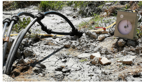
Drucktest durch Geo-Net srl über 2 Stunden
