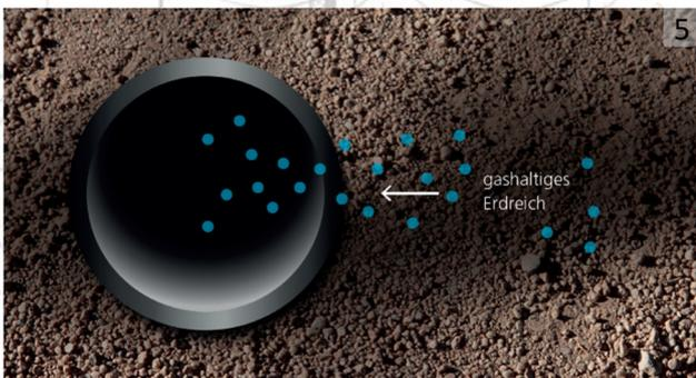
Image 5: Les gaz passent à travers la paroi des tuyaux dans le fluide caloporteur et sont transportés vers la pompe à chaleur.
