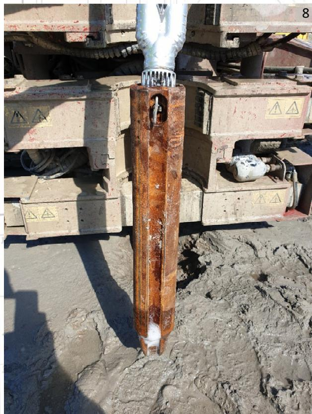
**Image 8:** GEROtherm® REX, simple U avec poids d'extension de 20 kg
