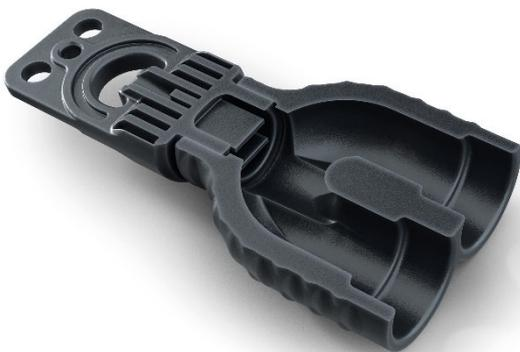
**Image 4:** résistance et stabilité améliorées grâce à une paroi renforcée au niveau du pied de la sonde; PN22 résistance hydraulique réduite grâce à de grandes coupes transversales et au soudage par manchon
