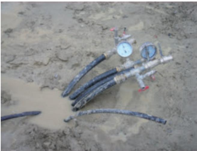
Essai de pression de sondes géothermiques HakaGerodur GEROtherm® posées
